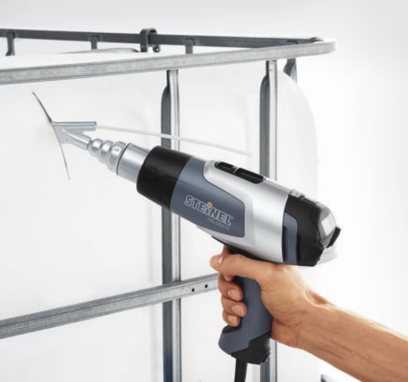
▲ Svejsning af vandtank HG 2320 E
