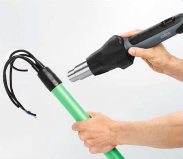
Industriel krympning af kabelstreng.
